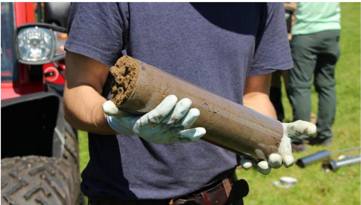
Dans le cadre de projets de recherche et de projets pilotes, le Centre de compétences sur les sols (CCSols) développe et perfectionne de nouvelles méthodes pour cartographier l'ensemble des sols de Suisse. Par exemple ici, avec un carottier de sondage novateur à [Fribourg-Chamblieux](#). (Photo : CCSols)
